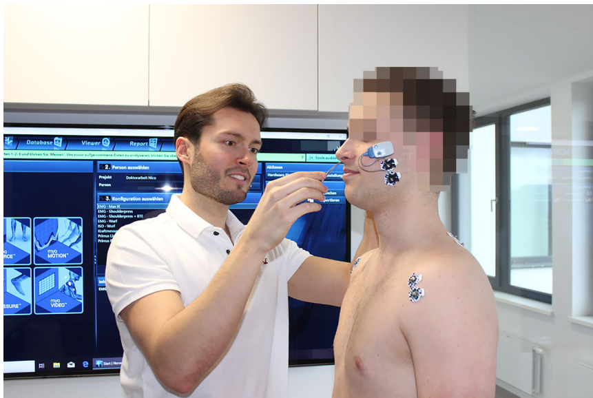
Abb. 3 ▲ EMG-basierte Messung der Muskelaktivität mit dem Noraxon MR3-System (Fa. Noraxon, Scottsdale, AZ, USA). (Mit freundlicher Genehmigung der Autoren)
